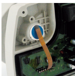
Capteur de pression interchangeable, voir page 4.09.
