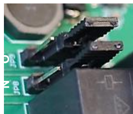
Réglage sortie 12V DC (continu) max 100 mA (Cavaliers à droite)
