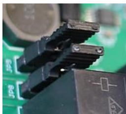
Réglage sortie contact sec max 3 A (Cavaliers à gauche)
