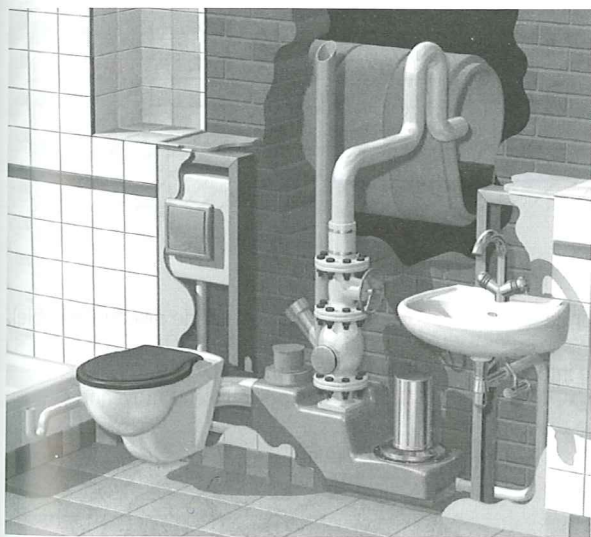
• MINI-SANITSON installé entre un mur et une cloison. Raccordements directs : douche, W.C., lavabo
