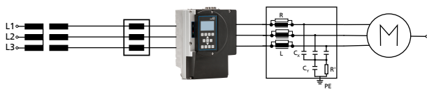
Montage du self de réseau et du filtre de sortie
