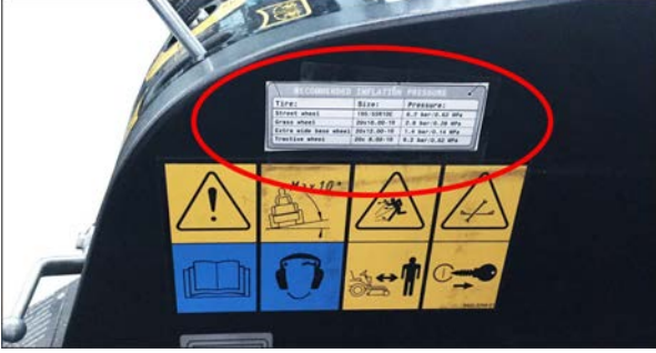
Şekil: Sürücü kabiniinde tavsiye edilen lastik basınçlarının yazdığı etiket
