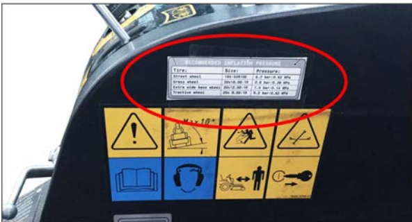
Slika: Nalepnica u kabini vozača sa preporučenim pritiscima punjenja
