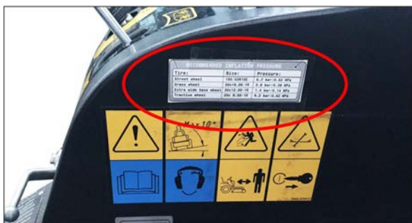
Ilustrace: Nálepka v kabině řidiče s doporučeným tlakem huštění pneumatik
