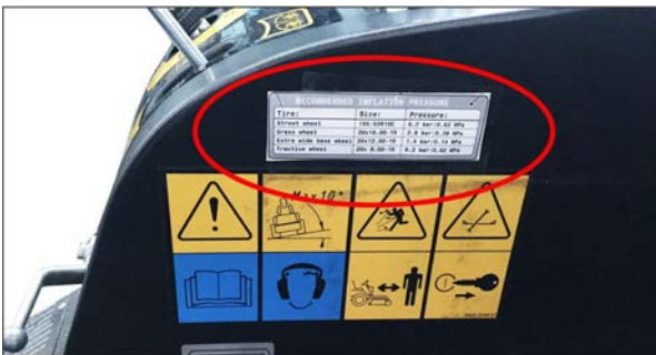
Slika: Naljepnica u kabini vozača s preporučenim tlakovima punjenja guma
