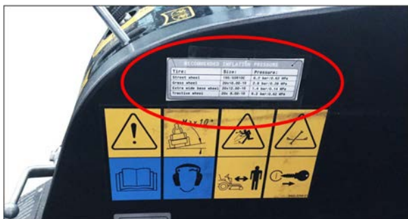
Figură: Autocolant în cabina șoferului cu presiunile în anvelope recomandate
