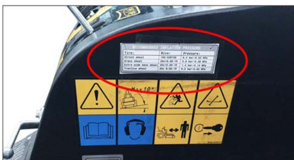
Фигура: Стикер с препоръчвани пълни налягания на гуми, поставен в кабината на водача
