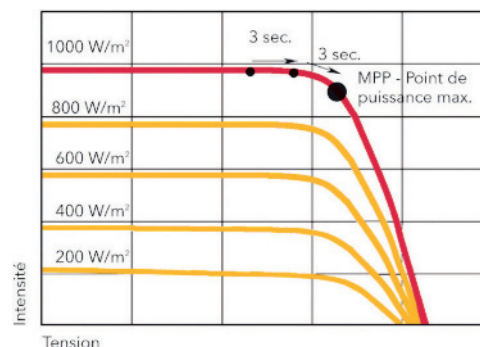
Courbes typiques courant / tension d'un panneau photovoltaïque
